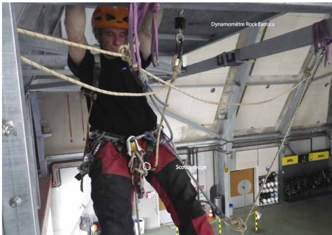
Photo 2 : José se prépare à chuter sur son descendeur. Nous pouvons observer le mou dans son descendeur. Il est contre-assuré par sa grande longe sur une corde secondaire. (photo P.-B.L.)
