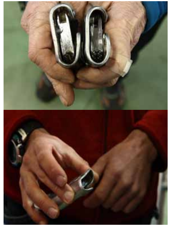
Photos 3 et 4. Le basic ancien modèle est déformé par l'ouverture et l'éjection de la corde. Photo J.B.
