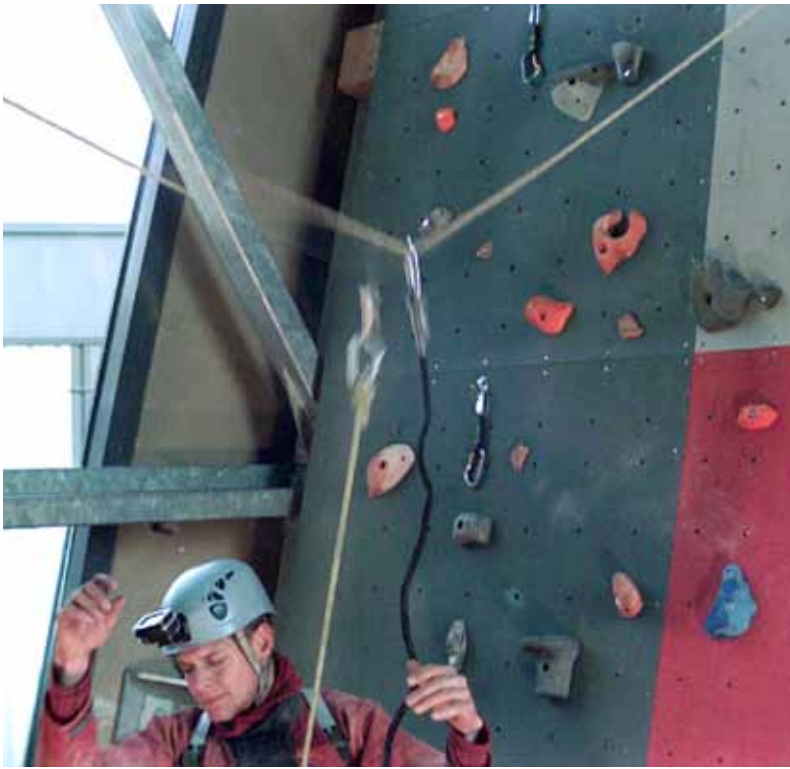
Photo 2. David chute et le bloqueur de poing (basic ancien modèle) s'éjecte de la corde. Seule la longe de sécurité retient le spéléologue. Photo J.B.
