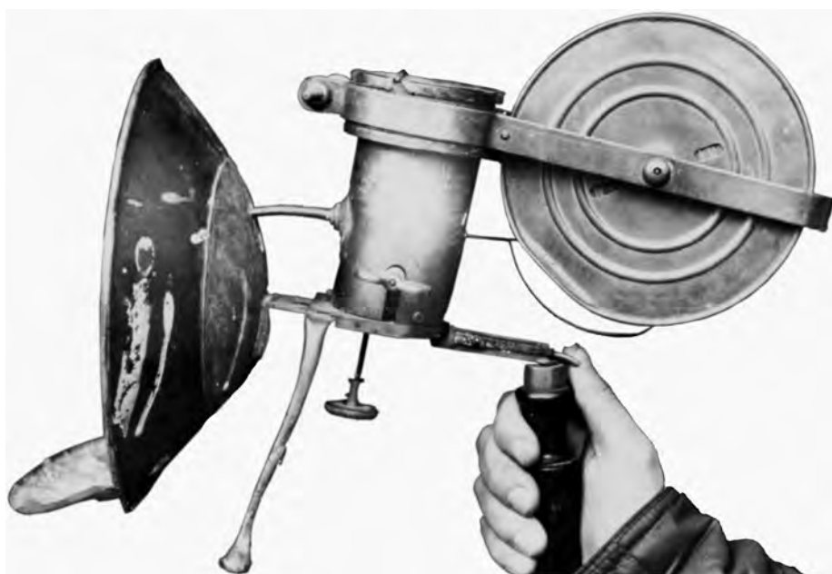
Figure 5 : Lampe à ruban de magnésium du type de celle de Louis Armand, à réflecteur et à mouvement d'horlogerie. Cliché Jean-Pierre Bonnebouche.
