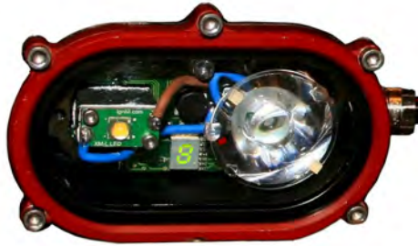
Indicateur numérique dans le boîtier des LEDs (Ignivi)
