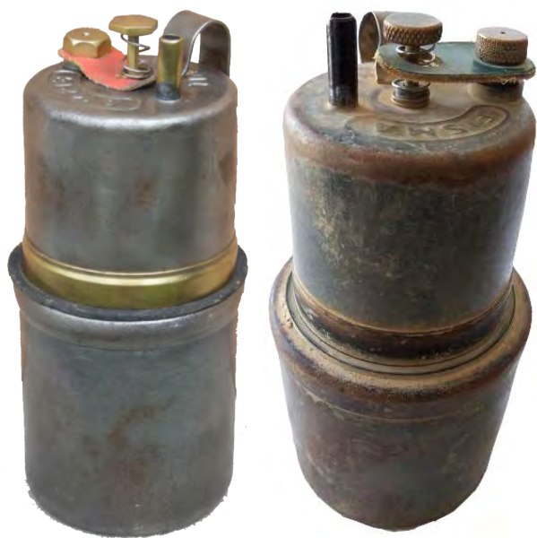
Figures 45 et 46 : Lampes espagnoles Fisma. Petit modèle (capacité en carbure 200 g) à gauche et grand modèle (capacité en carbure 300 g) à droite. Photos Bernard Sebillé.
