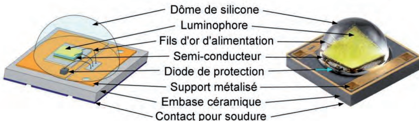
Figure 55 : Schéma d'une LED de puissance. Source : site Futura-Sciences.
