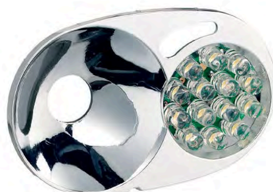
Figure 54 : Module de 14 LEDs de Petzl. Commercialisé à partir de 2005, il est toujours au catalogue Petzl en 2017 (Modu'LED 14 Duo, réflecteur double foyer + module de 14 LEDs avec trois modes d'éclairage constant, destiné à une installation sur les lampes frontales Duo et Duobelt). Source : Petzl.
