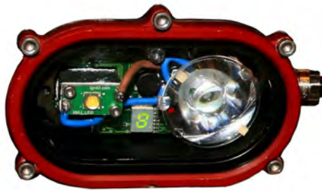
Indicateur numérique dans le boîtier des LEDs (Ignivi)
