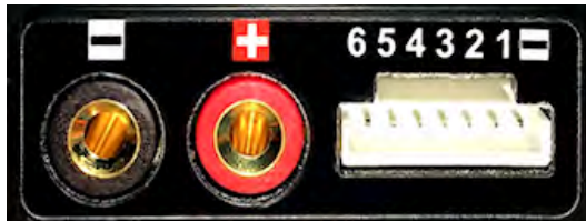
Figure 165 : Les sorties d'un chargeur dédié (6S).
