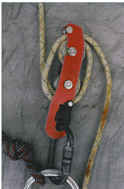
Freinage S+zéro. Ce dispositif utilise un peu plus de corde. Il faudra en tenir compte en ajustant les boucles de fractionnement
