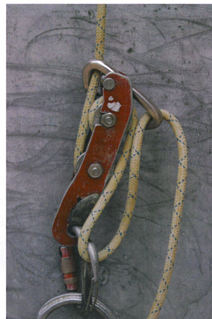
Freinage avec mousqueton supplémentaire au dessus du descendeur : dégagement d'équipier par exemple....
