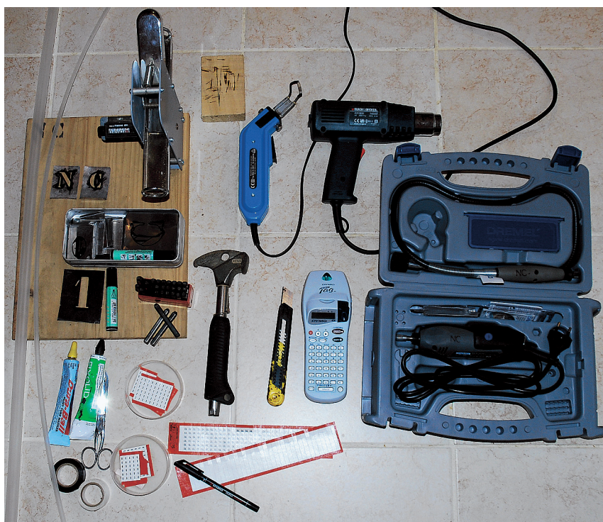
Gaine thermorétractable, pochoir, mesureur, planche à couper, coupe corde, décapeur (pour rétracter la gaine thermorétractable), micro-graveur, feutre indélébile, lettre à frapper, marteau, cutter, Dymo, stylo de peinture, ciseaux, bandelette de marquage, ruban adhésif.
