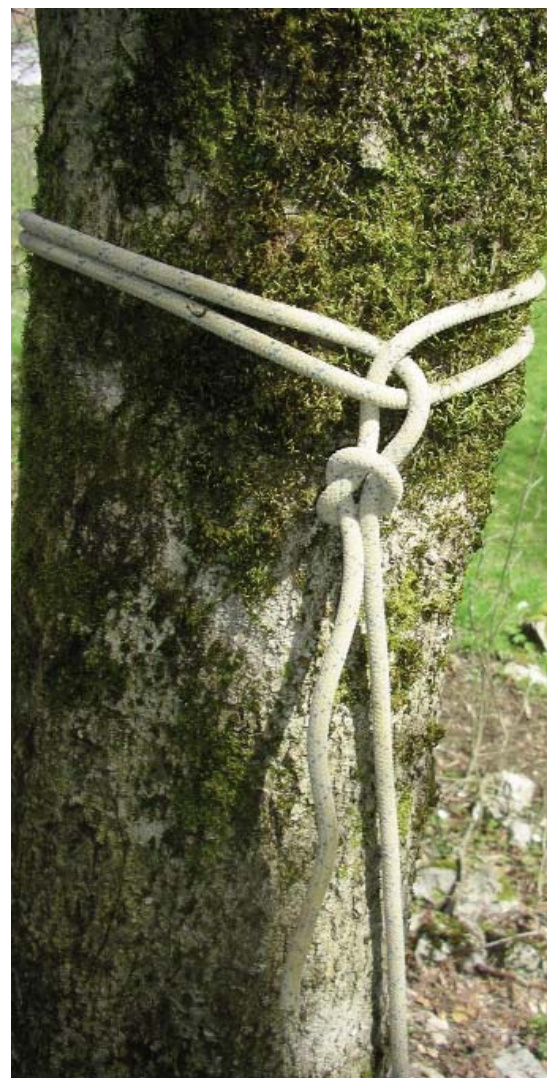
Nœud de cabestan avec clé d'arrêt : idéal en début de corde sur un amarrage naturel.
