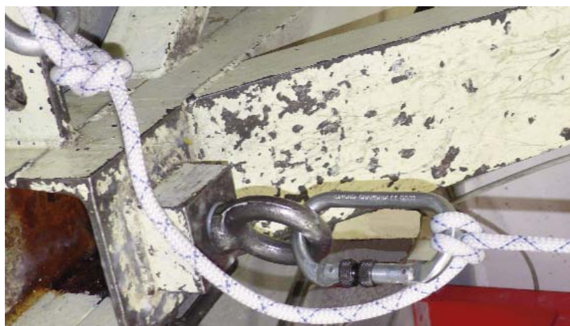
Configuration cabestan en main courante.
