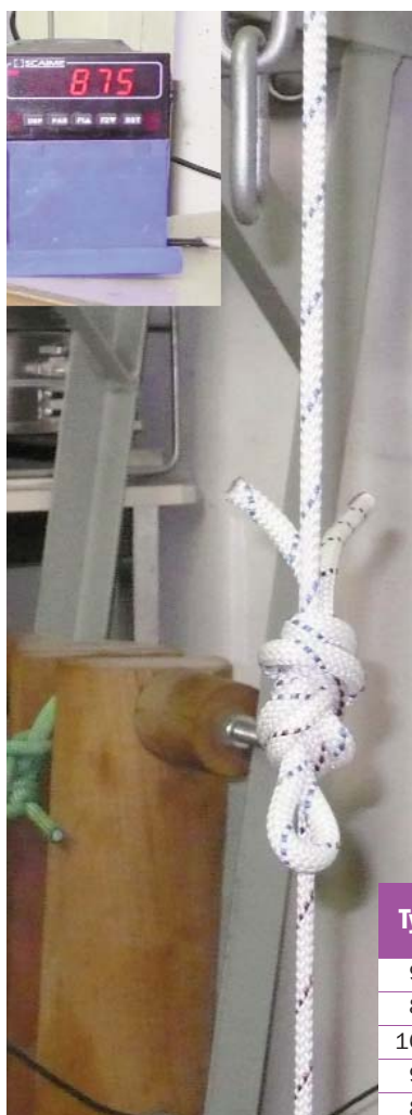
Test nœud de huit triple.
