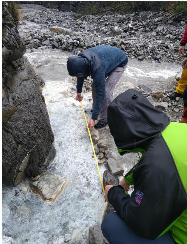
Photographie 9: Mise en place et calibrage du chenal pour l'estimation du débit de la source.
