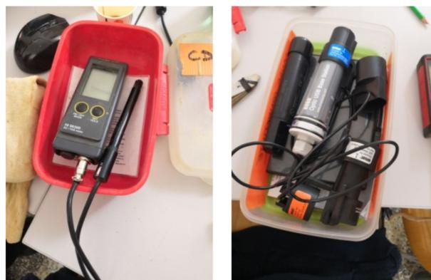
Figure 22: deux modèles de conductimètre couplés à des thermomètres.
