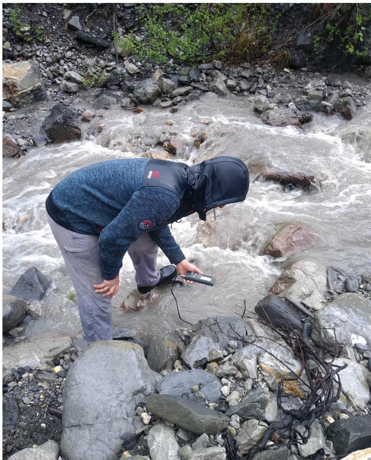
Figure 44: Mesure de conductimétrie et de température dans le lit du Riou. La sonde est immergée dans l'eau derrière le rocher aux pieds de l'opérateur. Photo L. Benoist
